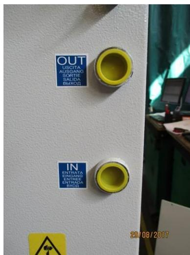
Figura 4 – Piastra connessioni idrauliche
