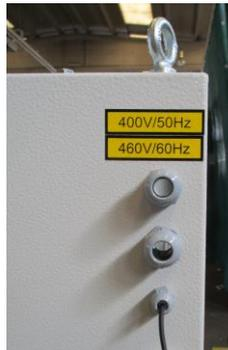
**Abbildung 11 – Stromanschlüsse**
