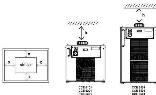
Figura 2 – Requisiti minimi di spazio,  $x=1.5$ ,  $h=0.5$  m
