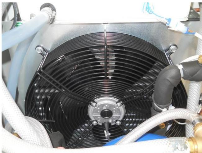
Figura 16– Esempio di direzione di rotazione del ventilatore
