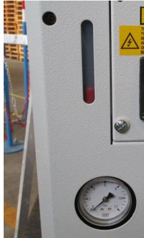
**Abbildung 10 – Befüllverfahren und Höchststand**
