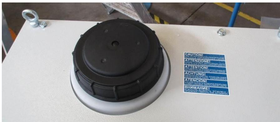
Figura 9 – Raccordo di riempimento
