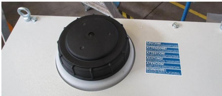
Abbildung 9 – Befüllstutzen
