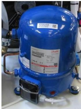
Abbildung 18 – Kompressor Platzierung für CCE 6401 – 6501 - 6601
