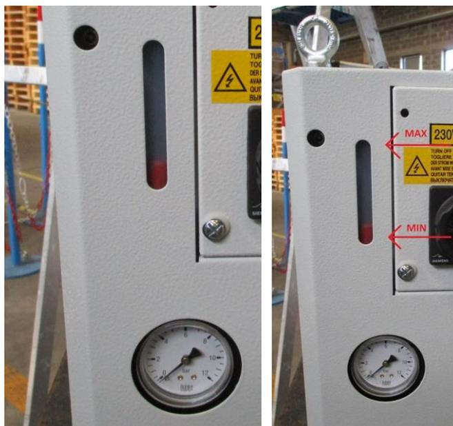
Figura 14 / 15 – Rabbocco del serbatoio
