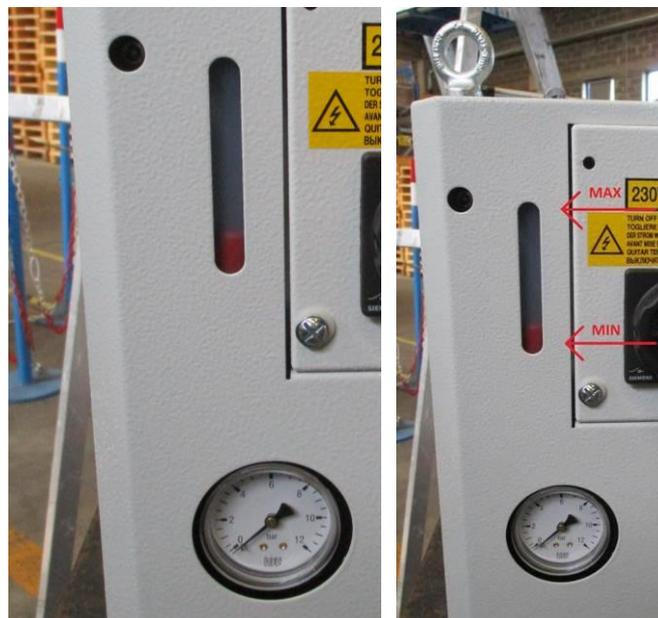
Abbildung 14 / 15 – Füllen des Tanks
