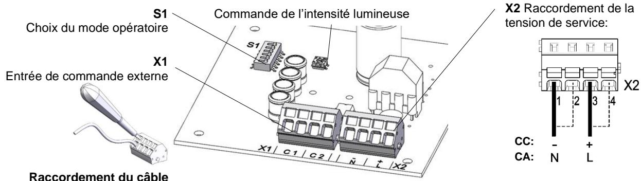
**Remarque:** Les appareils à tension continue (CC) sont dotés d'une protection contre l'inversion de polarité. Pas de fonctionnement en cas d'inversion de la polarité.
