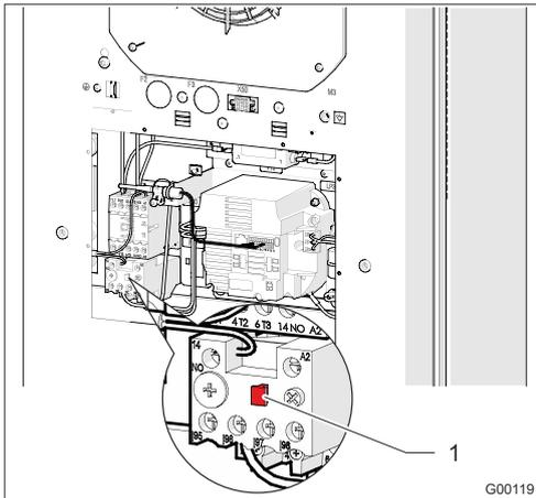
Abb. 24: Motorschutzschalter
