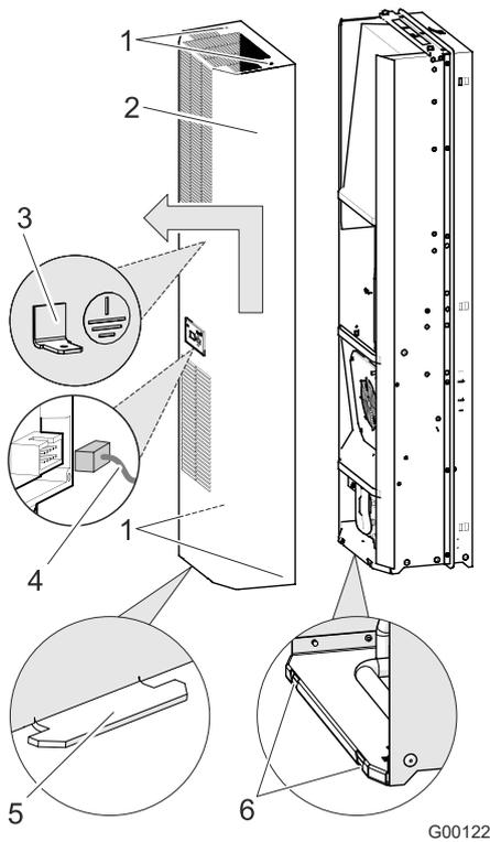
Abb. 22: Gerätehaube montieren
