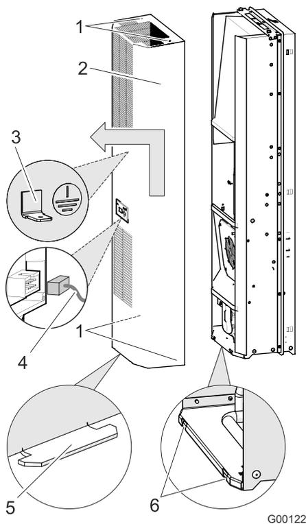
Fig. 22 : montage du capot de l'appareil
