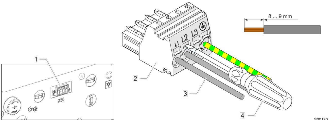
Fig. 17: Connettore di collegamento alla rete del condizionatore
