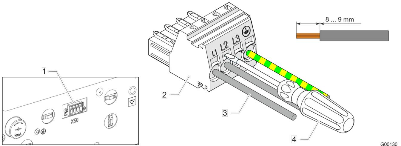
Abb. 17: Netz-Anschlussstecker Kühlgerät
