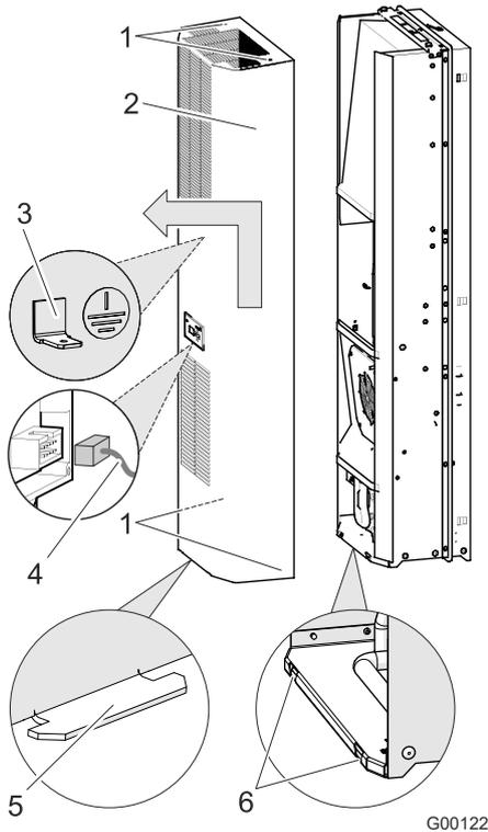
Abb. 21: Gerätehaube demontieren
