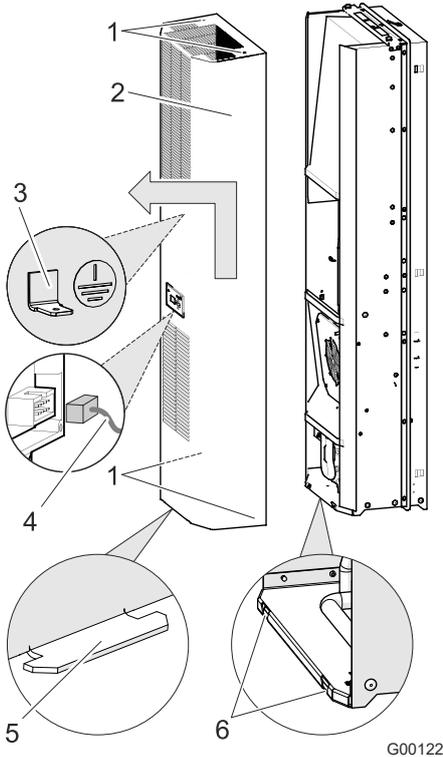
Рис. 21: Демонтаж кожуха устройства охлаждения
