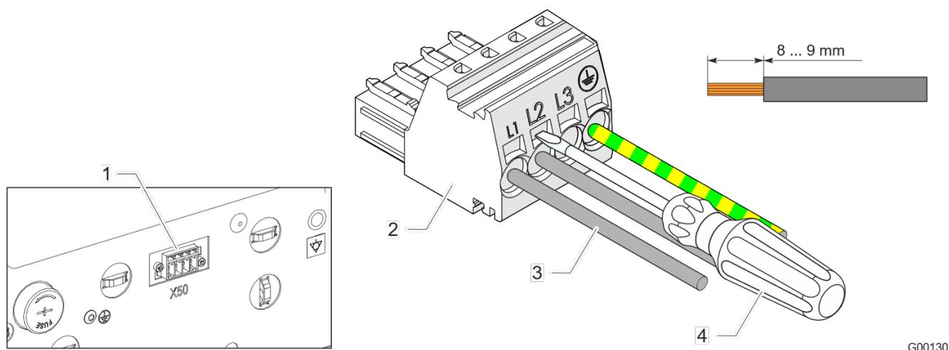
Рис. 17: Сетевой разъем устройства охлаждения
