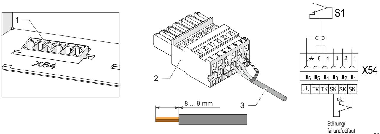
Fig. 15: Conexión del interruptor de contacto de puerta
